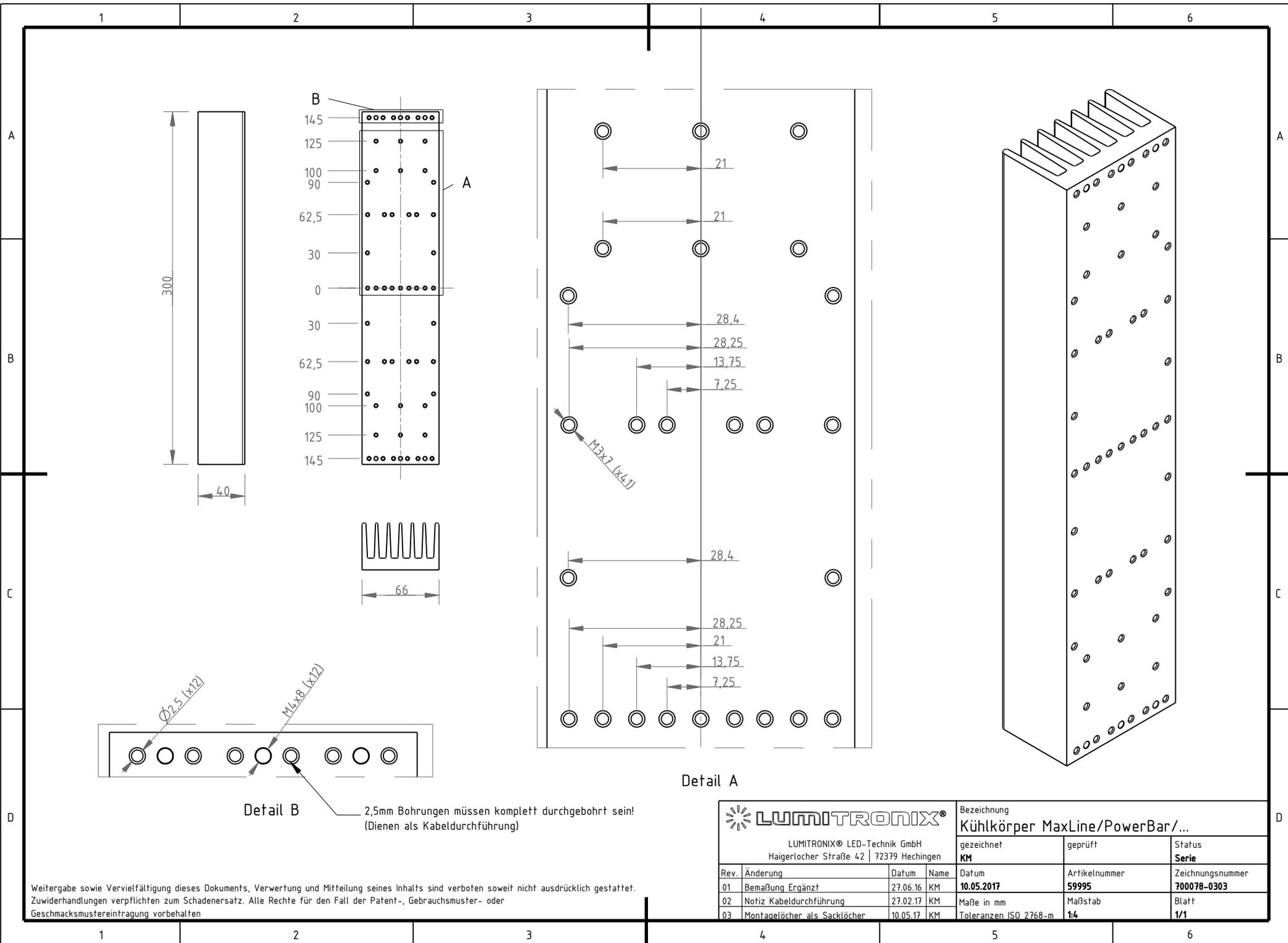
**Detail B** — 2,5mm Bohrungen müssen komplett durchgebohrt sein!
