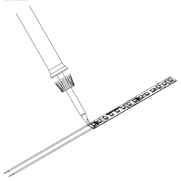
Der Anschluss der LumiFlex Economy LED Module erfolgt über eine Lötverbindung an den dafür vorgesehenen Anschlusspads.
